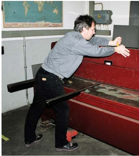
Abbildung 6: Beispiel für die Aufbringung von Kraft beim Einstellen der Maschine
