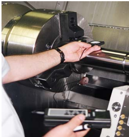
Abbildung 3: Überprüfung der Beleuchtung
