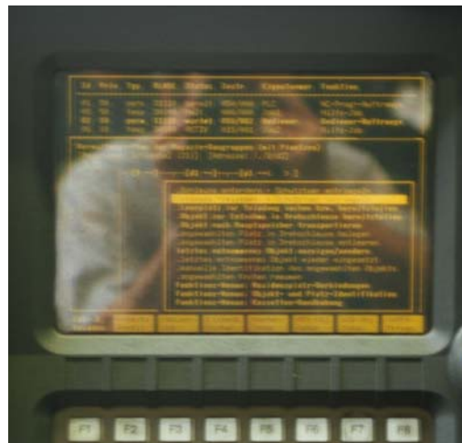
Abbildung 4: Unübersichtliches Eingabefeld (links), Reflexionen im Display (rechts)
