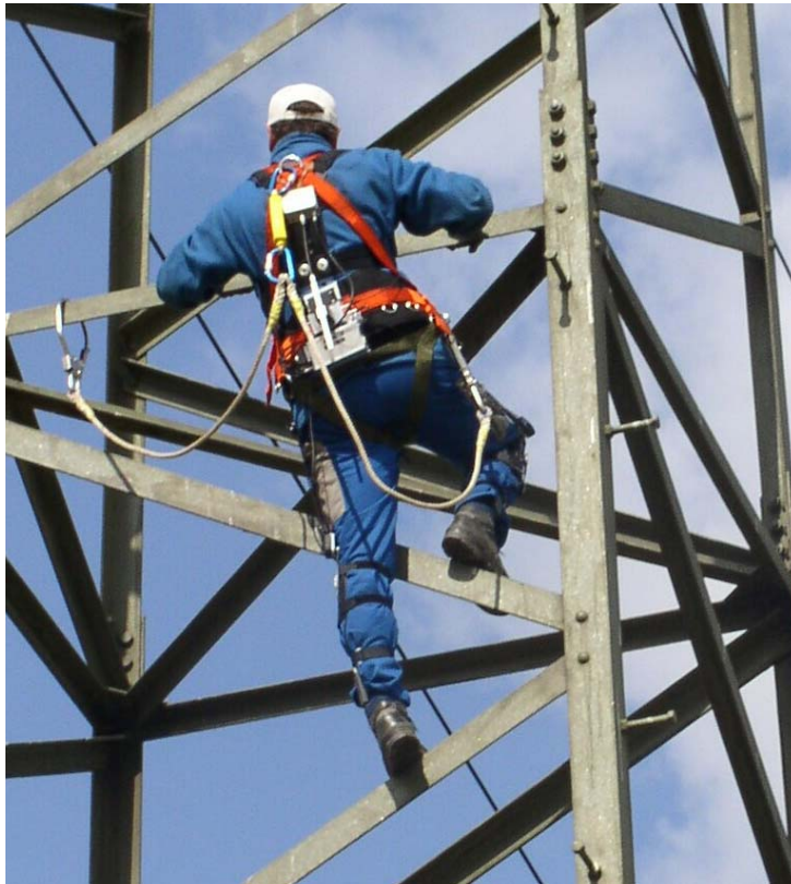
Abbildung 4: Einsatz des CUELA-Mess- systems bei einem Frei- leitungsmonteur
