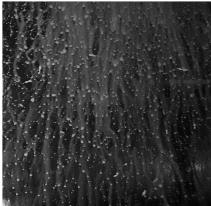
Abbildung 2: Kühlschmierstoffe behindern die Sicht auf den Bearbeitungsprozess
