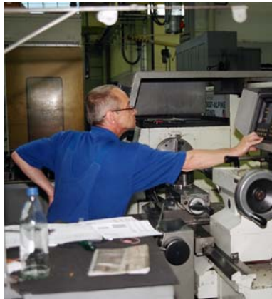
Abbildung 5: Beispiel für schlechte Erreichbarkeit der Bedienerschnittstelle
